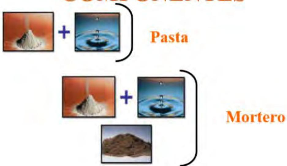
Cemento y agua conforma la pasta, y si le adicionamos arena obtenemos el mortero
