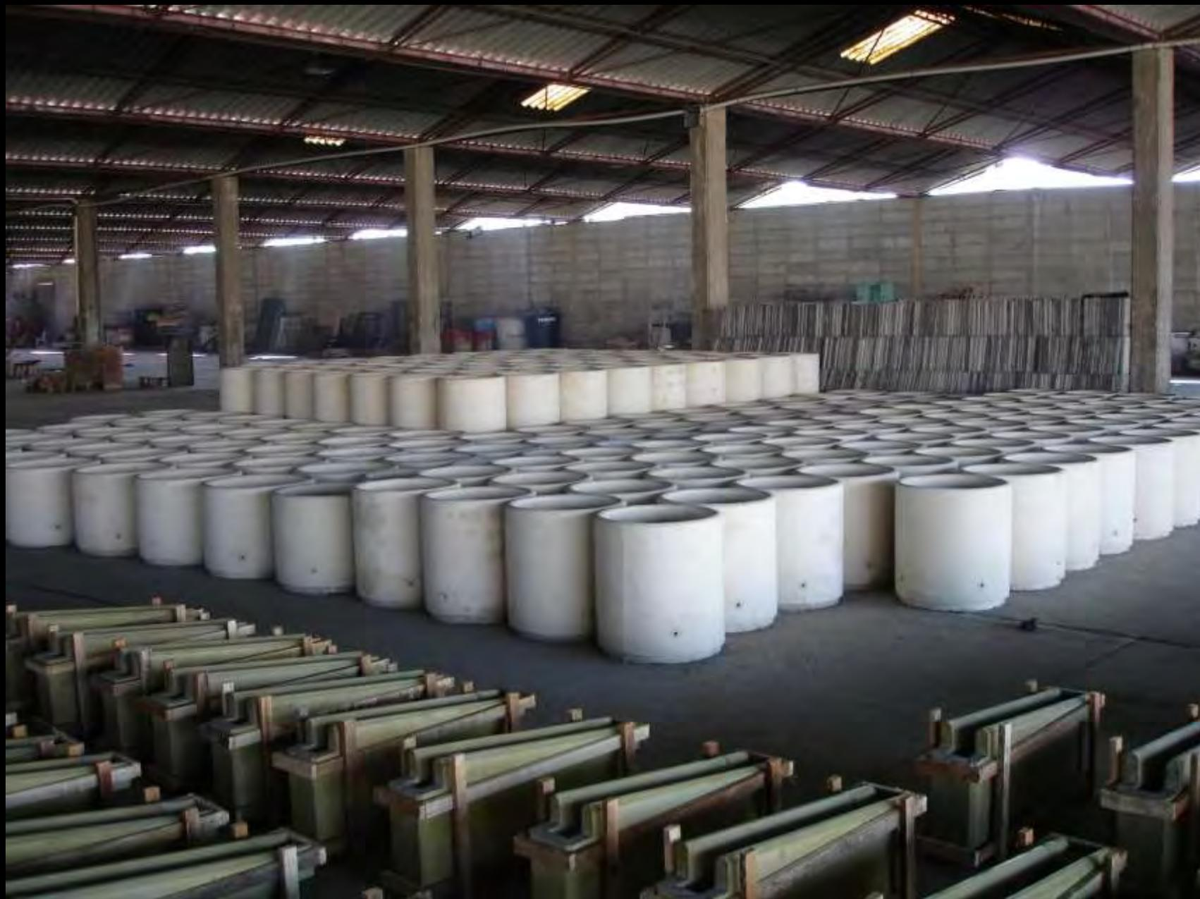
Materas y canales prefabricadas
