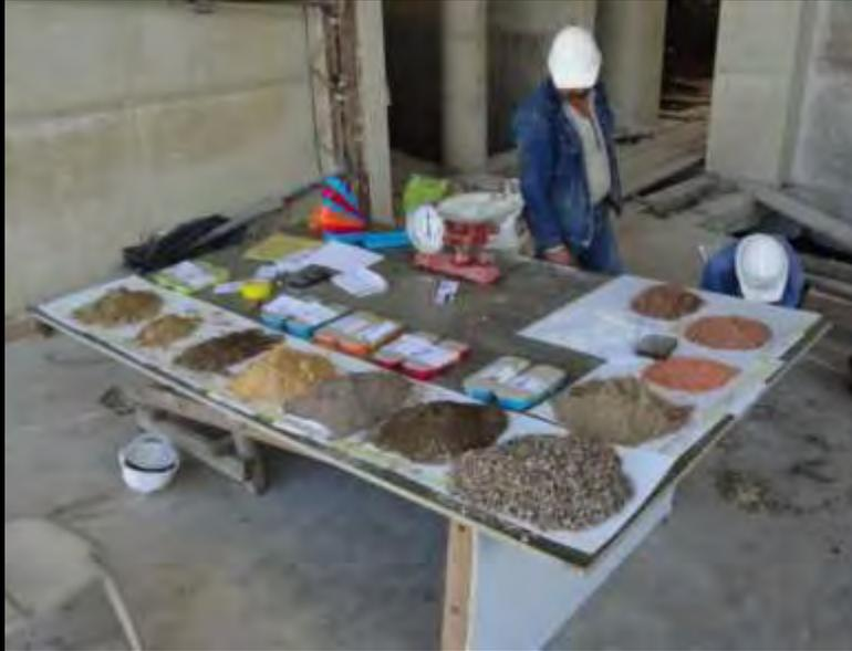
Ensayos para dosificación y definir color del concreto.
