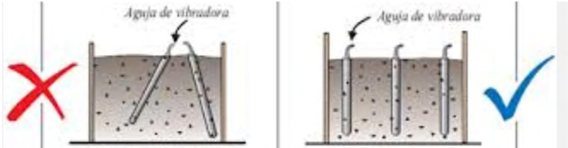
La aguja del vibrador debe penetrar en el concreto en forma vertical y NO de forma inclinada por la segregación que puede producir en el concreto.
